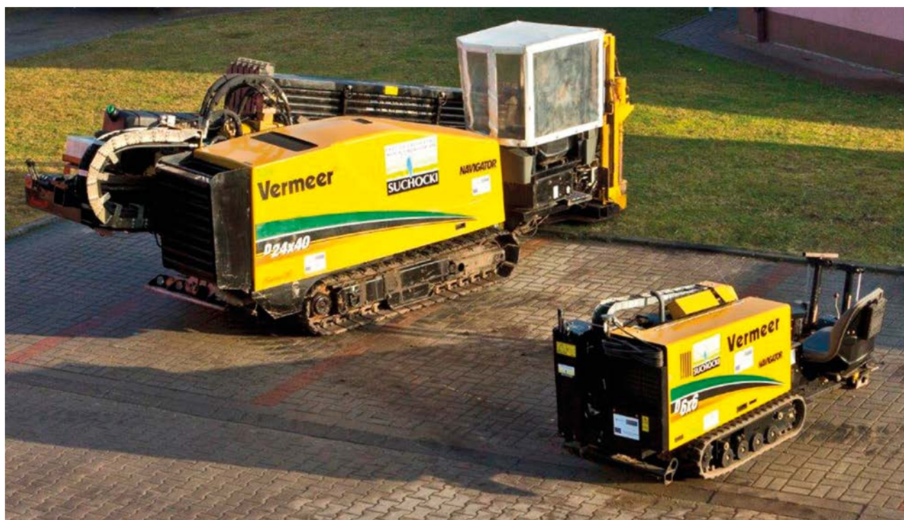
Wiertnica firmy Vermeer do wykonywania przewiertów horyzontalnych metodą bezwykopową. Fot. arch. Suchocki
