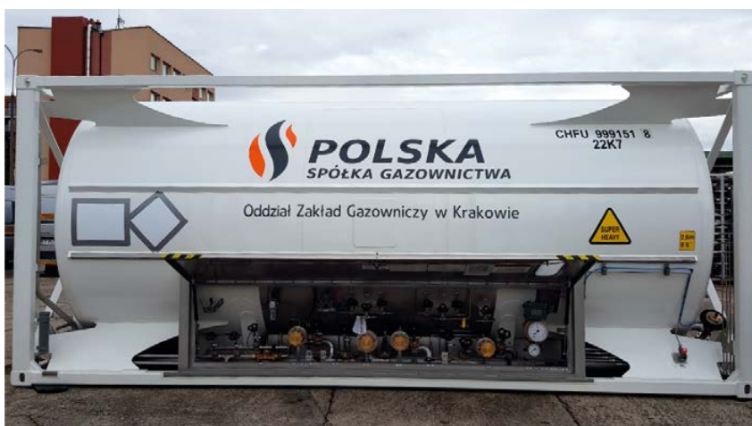
Fot. 6. Infrastruktura LNG na potrzeby zasilania awaryjnego (zbiornik cysterna w ramie kontenera ISO 20 ft.). Fot. arch. PSG sp. z o.o. Oddział Zakład Gazowniczy w Krakowie
