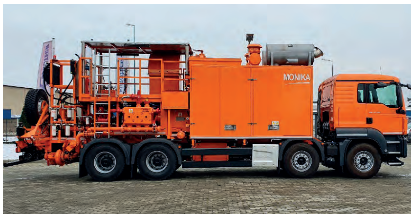
Fot. 1. Dwupompowy agregat cementacyjny CPT 720. Arch. Exalo Drilling S.A.
