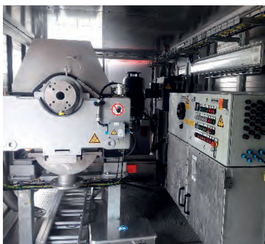
Fot. 5. Wirówka dekantacyjna produkcji firmy Flottweg (model: Z4E-4/451). Arch. Exalo Drilling S.A.
