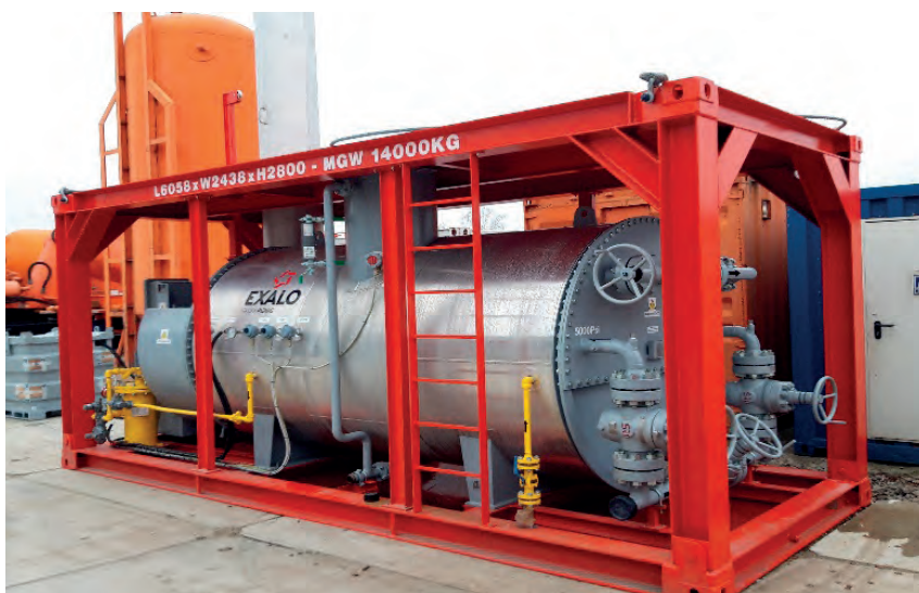
Fot. 3. Podgrzewacz płynów złożowych – Heater. Arch. Exalo Drilling S.A.
