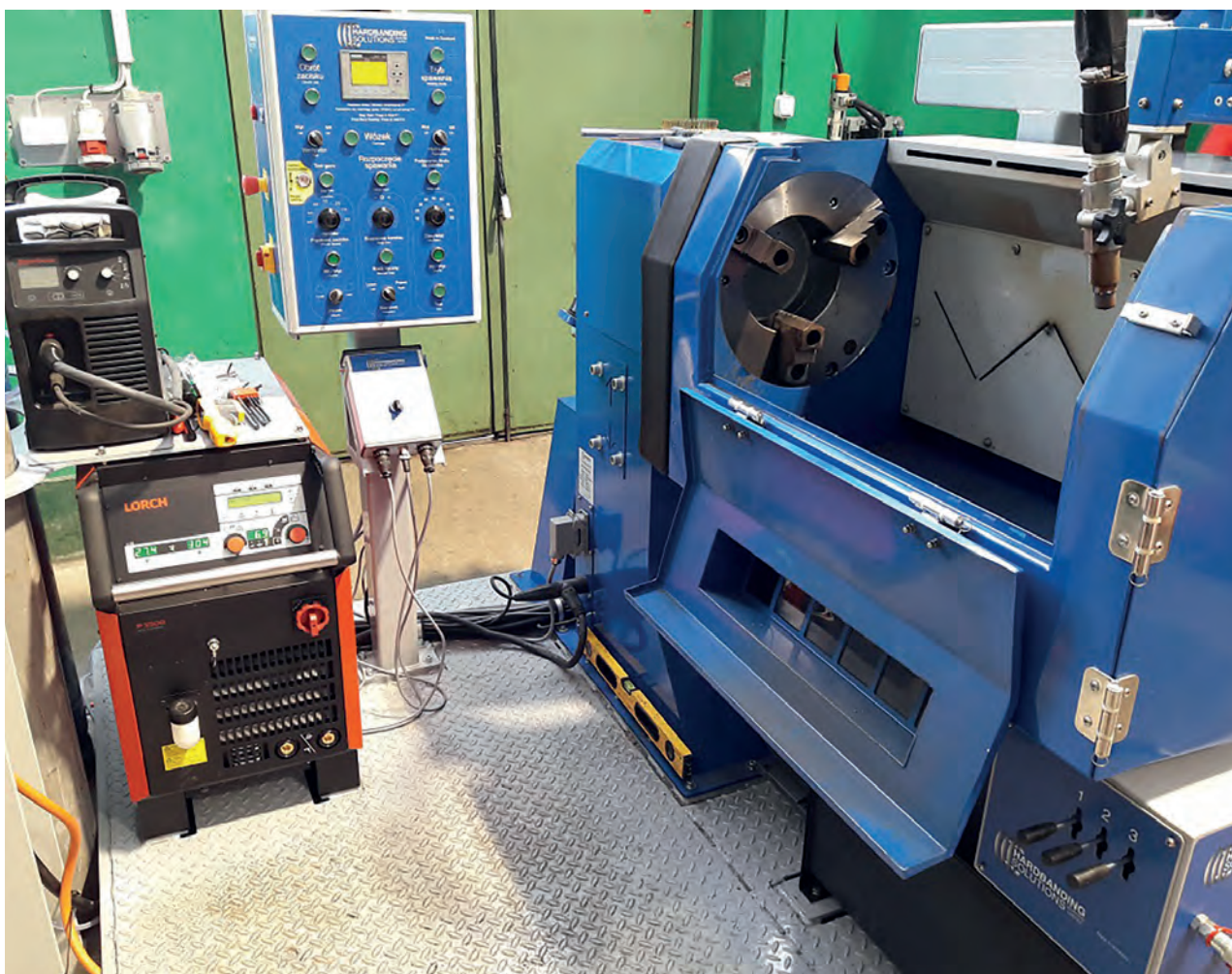
Fot. 6. Urządzenie do regeneracji zworników przewodów wierniczych Skye HB 101. Arch. Exalo Drilling S.A.
