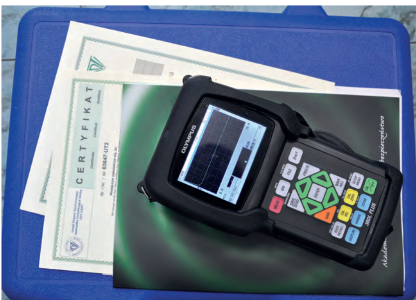
Fot. 4. Ultradźwiękowy aparat do badań nieniszczących. Arch. INiG - PIB
