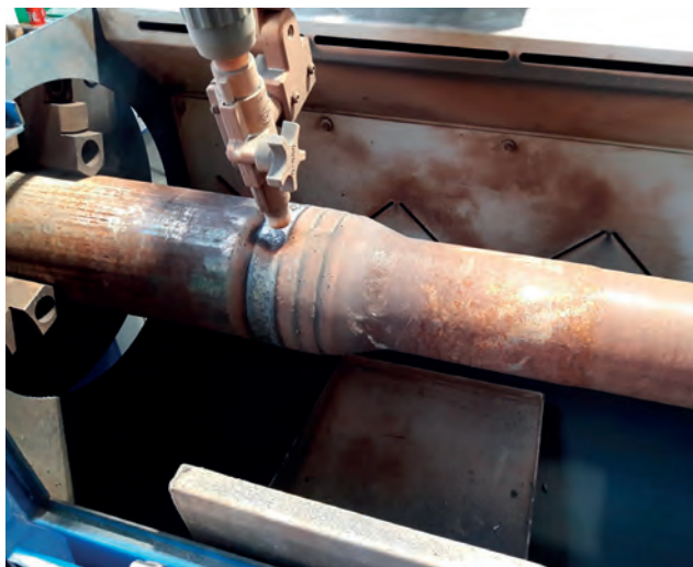
Fot. 5. Zregenerowany przewód wierniczy za pomocą Hardbandingu. Arch. Exalo Drilling S.A.
