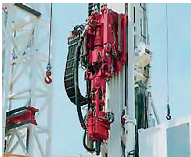
Top Drive w osi otworu wierniczego (źródło: Drillmec SPA)
