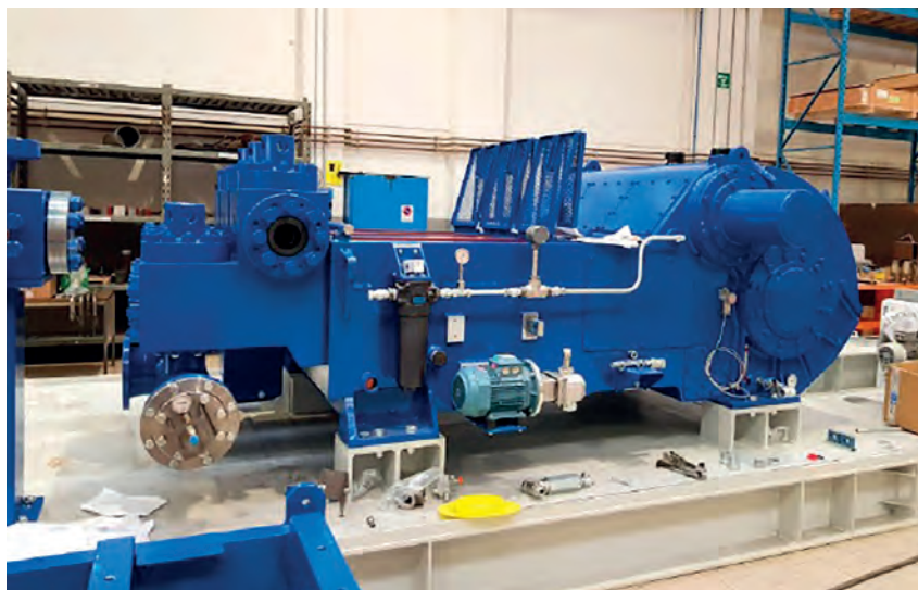
Pompa płuczkowa 9T1000 w trakcie montażu (źródło: Drillmec SPA)
