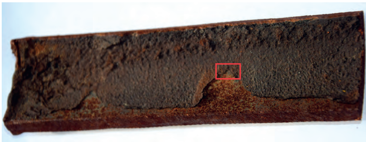
Fot. 5. Fragment rury wydobywczej z użyciem inhibitora korozji stosowania ciągłego. Arch. INiG - PIB
